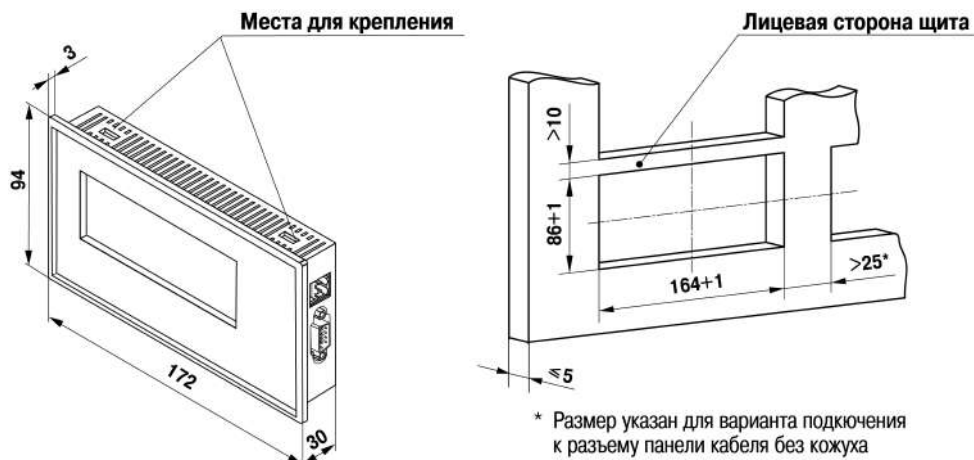
Рисунок А.1 – Габаритные и установочные размеры
